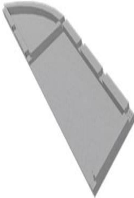
Figura 23 - Viga-laje
